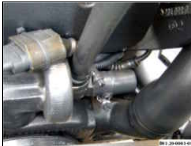
Toma de agua para calefacción L915 B83.20-0005-01
