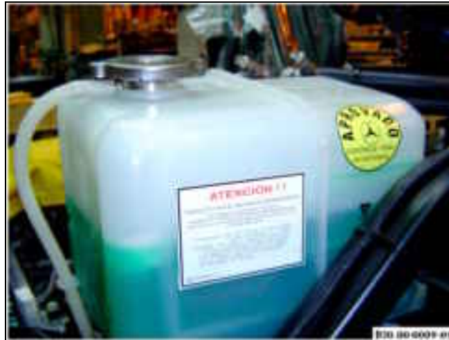
Depósito de compensación L0915 B50.00-0089-01
