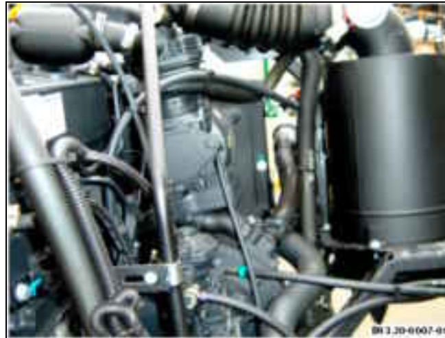
Retorno de agua del sistema de calefacción LO 712/812 B83.20-0005-01
