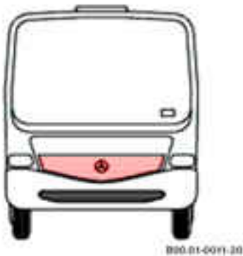
Rejilla de captación de aire B00.01-0011-20
