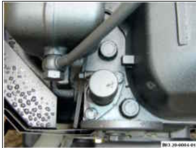
Toma de agua para calefacción LO712/812 B83.20-0004-01
