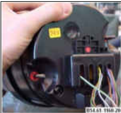
Parte Posterior del tacógrafo con lacre B54.61-1160-20
