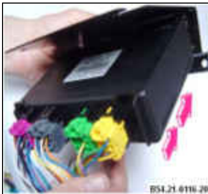
Encastre del módulo ADM B54.21-0116-20
