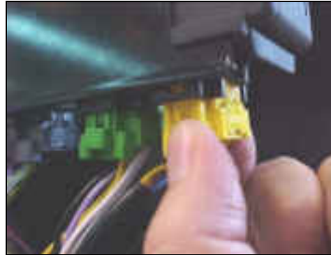
conectores del módulo ADM B54.18-0054-06
