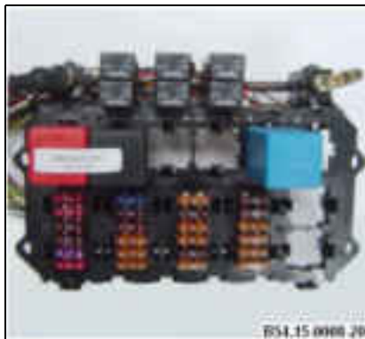
Central eléctrica - "FUSE BOX" B54.15-0008-20
