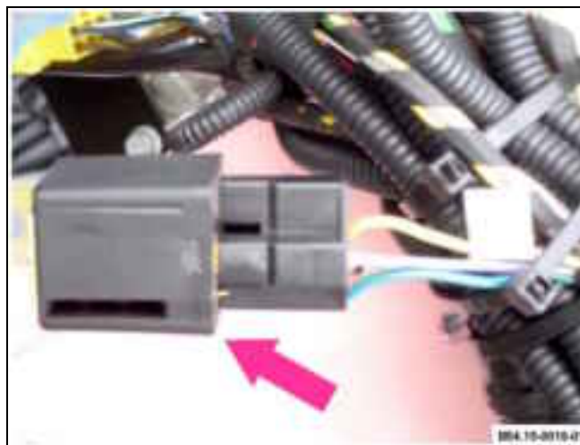
Relé chicharra de alarma acústica (T1) B54.15-0016-01
