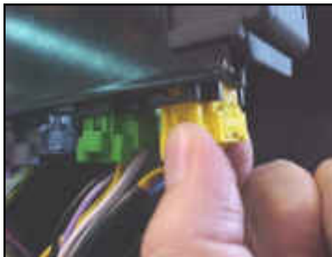
Conectores del módulo ADM B54.18-0054-06
