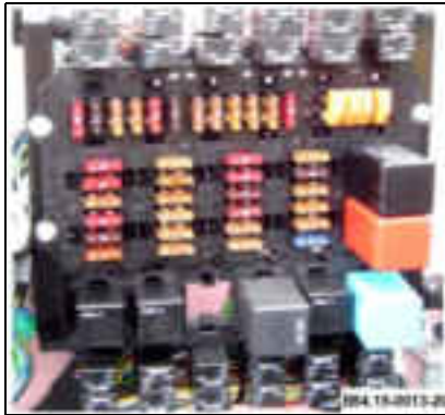
Centralita eléctrica - "FUSE-BOX" B54.15-0013-20
