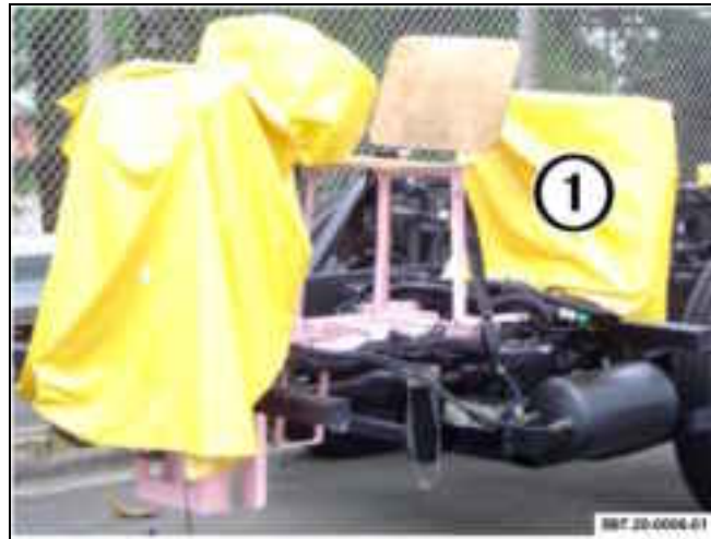
Cubierta de protección de la centralita eléctrica B97.20-0006-01
