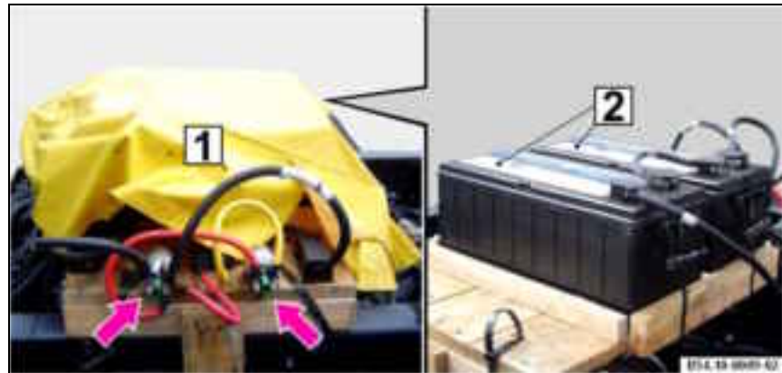
Compartimiento de la batería B54.10-0009-02 Relés electrónicos (flechas)
