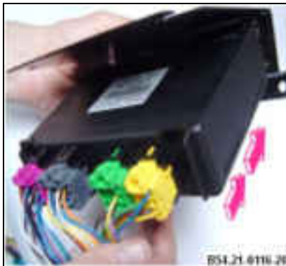
Encastre del módulo ADM B54.21-0116-20
