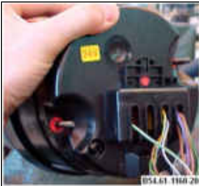
Parte Posterior del tacógrafo con lacre B54.61-1160-20
