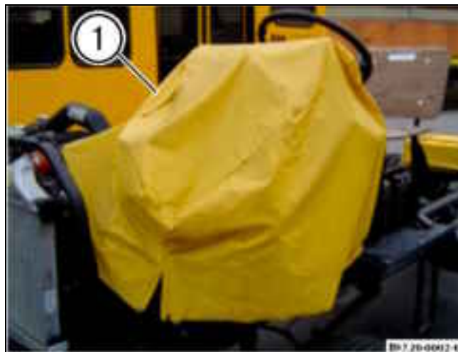
Cubierta de protección del podest B97.20-0002-01
