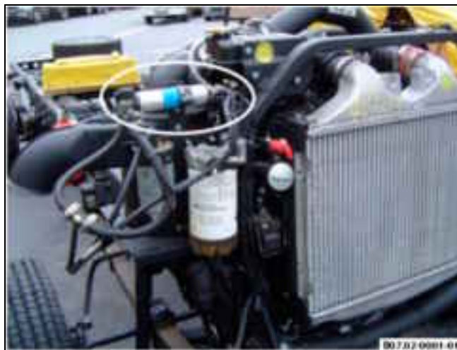
Bomba en el filtro de combustible B97.20-0002-01
