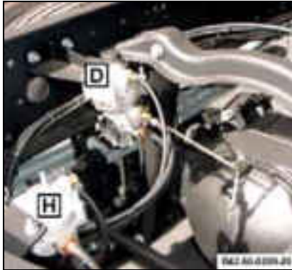
H - Válvula relé nº A695 429 71 44 D - Válvula ALB (Substituir por relé)
